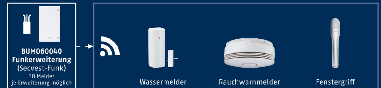
Die Secoris BUS-Funkerweiterung BUM060040 schafft die Brücke zu den Funkmeldern, mechatronischen Sicherungen und weiteren Funkkomponenten der Secvest. Zum Upgrade einer Bestandsanlage von Secvest auf Secoris wird nur die Zentrale getauscht und die Funkerweiterung installiert. Bisherige Funkkomponenten arbeiten einfach mit der Secoris weiter.
