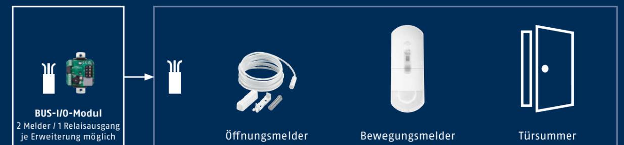
Mit dem Mini-Modul lassen sich Drahtmelder frei im Gebäude platzieren und einfach am System-BUS andrahten. Das Modul mit integriertem Relaisausgang passt in eine Schalterdose (55 mm), die neben den Meldern gesetzt wird. Dies spart Kabelstrecke und Arbeitszeit bei der Installation.
