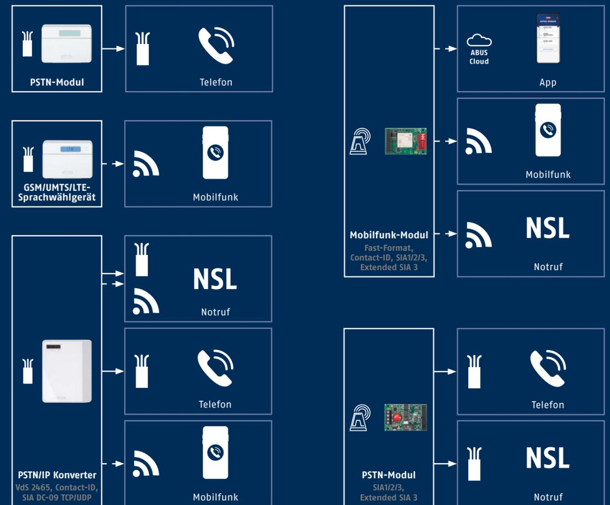
Nicht zum Heulen: Ist im Objekt der Externalarm mit lauter Außensirene nicht erwünscht oder ausreichend, erfolgt der Fernalarm an gespeicherte Telefonnummern oder Notruf- und Service-Leitstellen (NSL). Bei Bedarf (z. B. Netzwerkausfall) auch über Mobilfunk.
