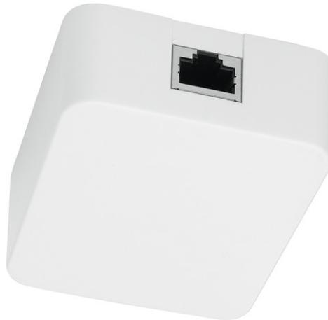
Ce splitter PoE (Power Over Ethernet) permet d'alimenter en tension des terminaux de réseau de 5 V CC, tels que les caméras réseau d'ABUS non compatibles PoE, à l'aide du câble CAT5/CAT6. Ceci présente un avantage là où il n'y a pas de prise de courant.
